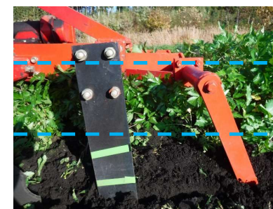
写真4 作業機の角度の参考図 作業機は苗床と平行にする
