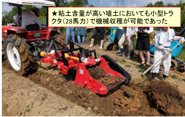
図 岡山県井原市野上町の栽培3年目シャクヤク「べにしずか」におけるモデル収穫機の導入、2017年10月10日に撮影。振動式サブソイルとポテトディガーをベースとし、ストロン等の切断機構を有した収穫機の開発（特許6880524号）により、小型トラクタ（28馬力）でシャクヤクの連続機械収穫が可能であった。
