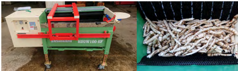
加工調製試験に用いたサトイモ洗浄機 (指浪製作所製, HDUW100-6F, ブラシ:0.5NY×6本)。
