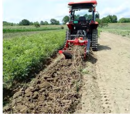
図 収穫機の動作(写真左)および掘り上げた状態(写真右)。村上ら(2021)、薬用作物栽培の手引き～薬用作物の国内生産拡大に向けて～カンゾウ編, 農研機構( https://www.naro.go.jp/publicity_report/publication/files/kanzo_war_c_man2021.3.15.pdf )より引用。
