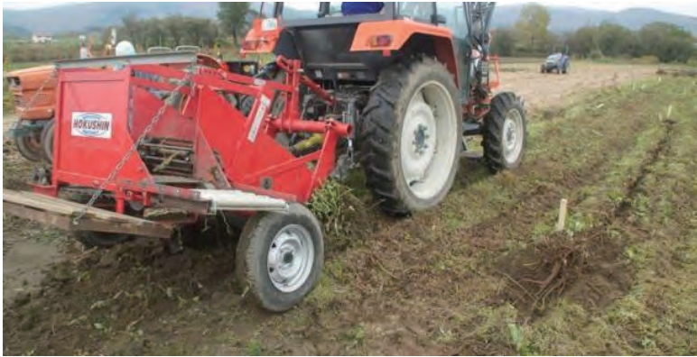
ワサビダイコン収穫機（掘取幅を広げたタイプ）を用いた収穫作業
