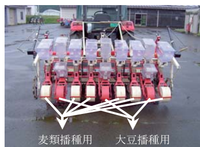
写真2 東北農研が製作した麦類・大豆同時播種機。麦播種用と大豆播種用の播種ユニットを交互に配置する。代かきハローが前置されている。
