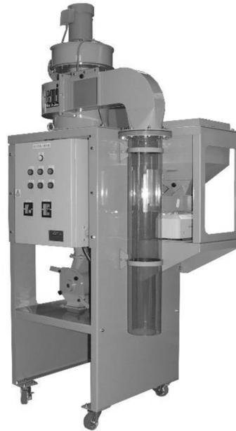
図 2-2-5 吸引型風力選別機（提供：株式会社原島電機工業）
