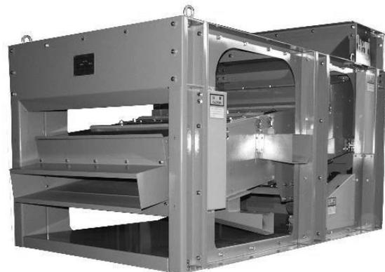
図 2-5-3 前後傾斜揺動式 (提供：株式会社原島電機工業)
