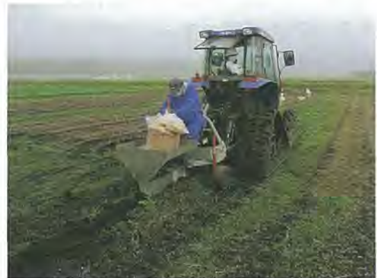
写真3 モミガラ再充填機の走行時全景
