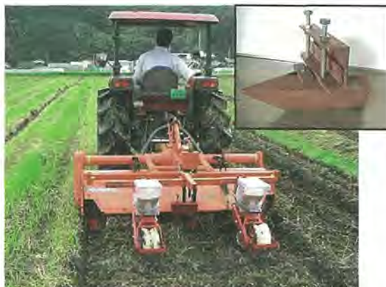
写真3 簡易畦立て機の構造
