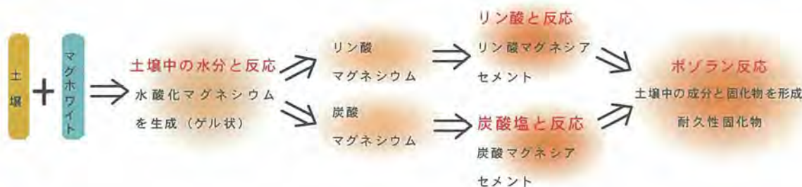
図7 マグホホワイトによる土の固化原理
