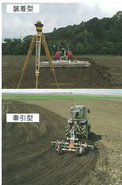
写真1 レーザーレベラー
