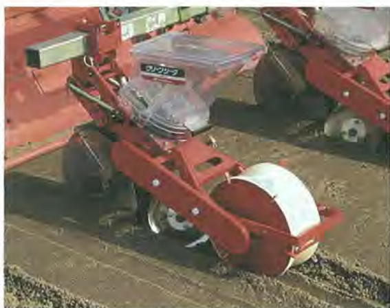
図1 山形鎮圧輪による鎮圧状況
