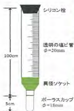
図1. 灌水の必要性を判定する測器
