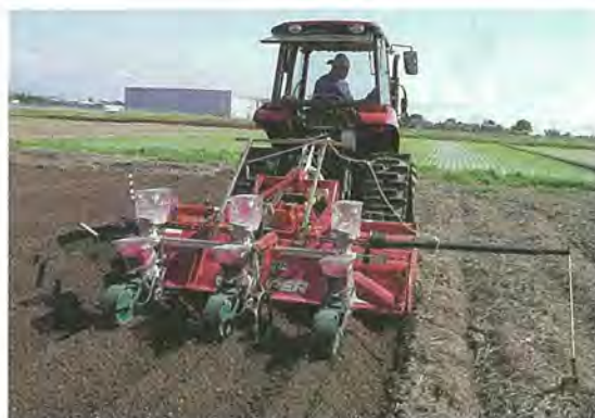
写真1 耕うん同時畝立て播種作業機（左：2条用、右：3条用）
