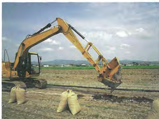
写真2 アーム式ガイド掘削機
