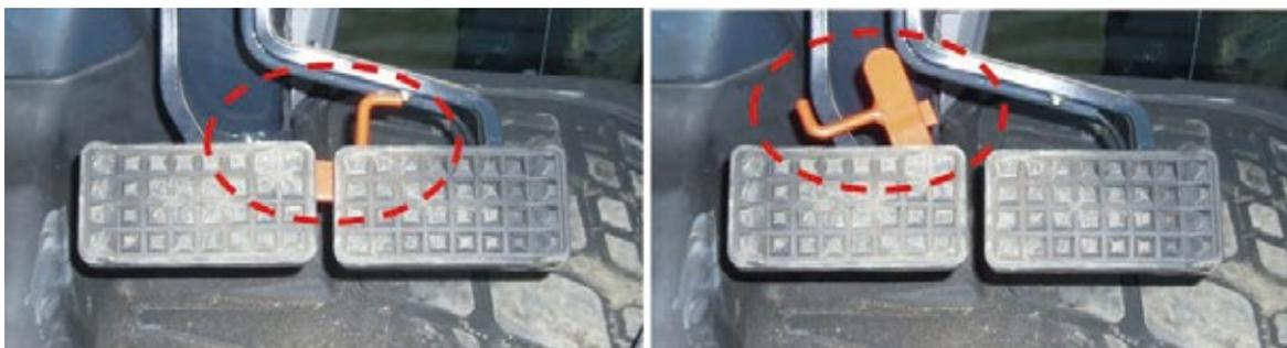
図10 左右ブレーキは、ほ場を出る前に必ず連結しましょう（左：連結状態 右：非連結状態）
