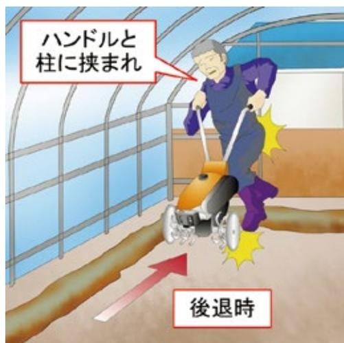
図 12 歩行型トラクターによる挟まれ事故例
