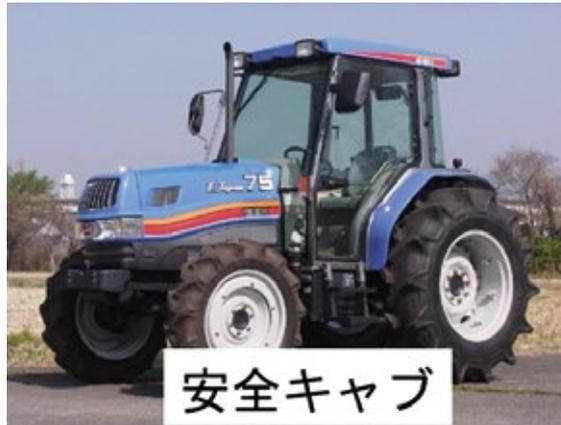
図8 乗用型トラクターの安全キャブ・フレーム
