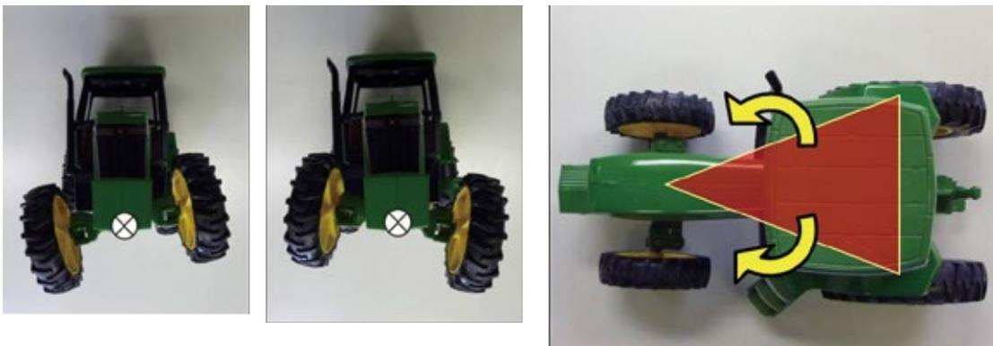
図7 乗用型トラクターは3点で支えられている
